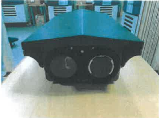
그림 1) 근거리(주요목) 카메라 하우징 (SOH-1500)
