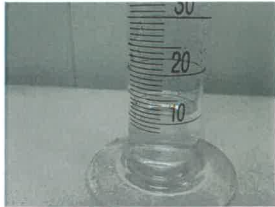
그림 5) 분무량 채취량 : (약 12 ml) 약 1.50 ml/h, 8 시간 기준
