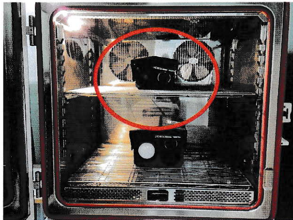
그림 9) 시험품 설치 사진 (내습성2)
