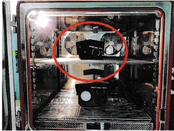
그림 5) 시험품 설치 사진 (내습성1)
