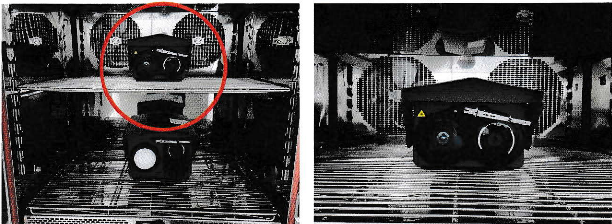
그림 3) 시험품 설치 사진 (내열성)
