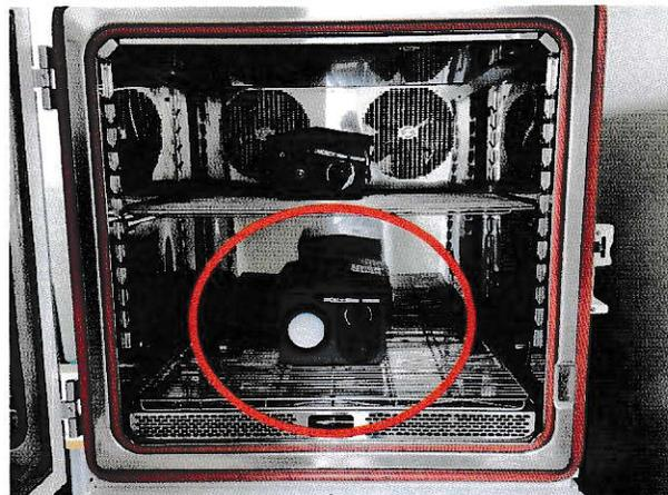
그림 7) 시험품 설치 사진 (내한성)
