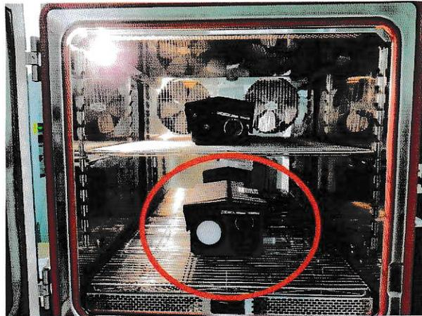
그림 5) 시험품 설치 사진 (내습성1)
