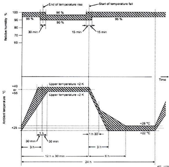
그림 2) 내습성 시험 사이클
